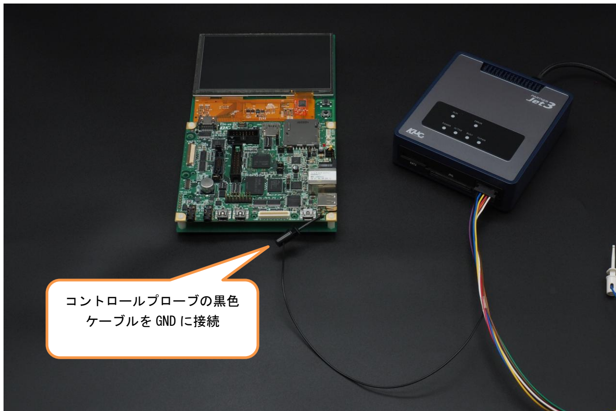
図 2-8 ホットプラグの準備(GND線の接続)
